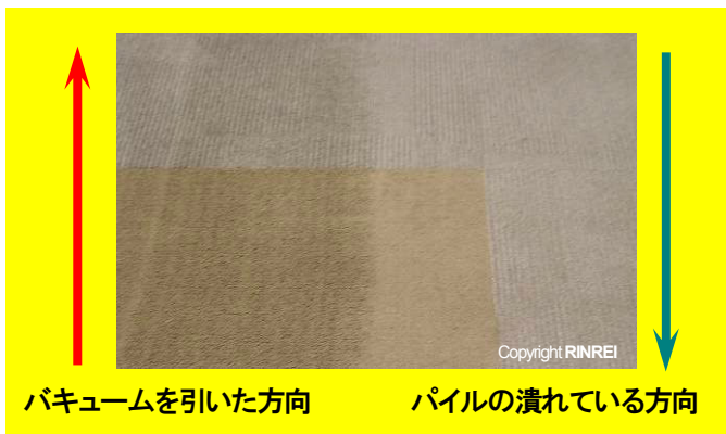
アップライトバキュームを使用したバキューム作業の方向
